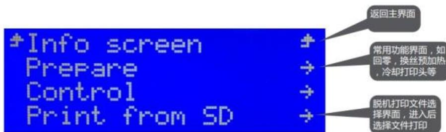
图 3 3D 打印机控制面板
